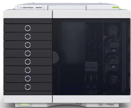
1290 Infinity II Multisampler с 8 выдвигаемыми отделениями вмещает 16 микропланшетов общей емкостью 6144 пробы.
