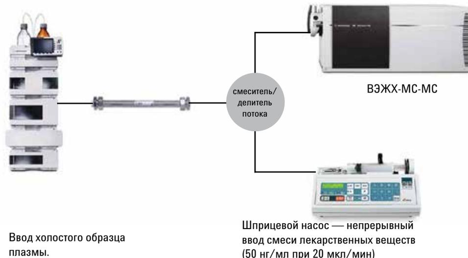
Рис. 1. Схема эксперимента по сравнению величины ионной супрессии
