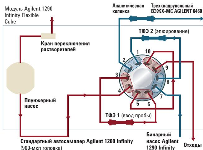
Рис. 1. Схема внутривиточного процесса
